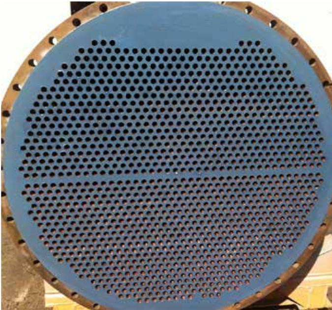
Belzona 1321 (Ceramic S-Metal) ist ein hochfester Zweikomponenten-Werkstoff zum Schutz der Anlagen vor Erosion/Korrosion.
