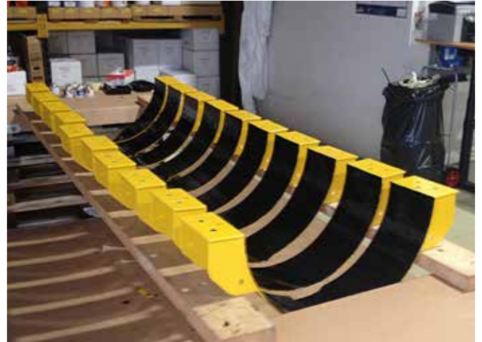
Schellen im Spritzwasserbereich beschichtet
